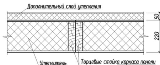
Рис. 4. Узловое сопряжение панелей с дополнительным утеплением снаружи.
